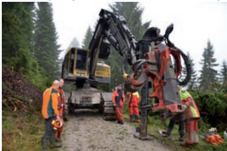
Oben: „Einweisung“ des Seilbaggerteams durch Revierleiter Werner Schmidt; unten: beim Ablängen; links am Ausleger ist die Seilwinde erkennbar
