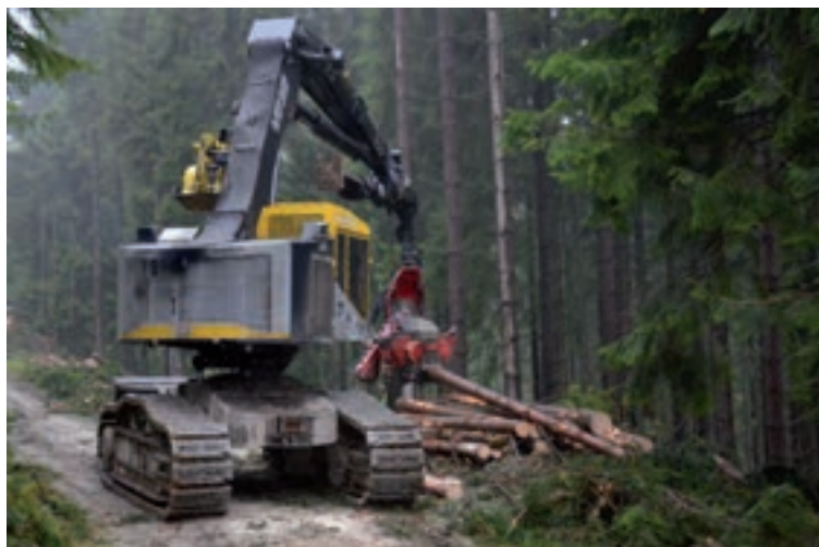
Oben: „Einweisung“ des Seilbaggerteams durch Revierleiter Werner Schmidt; unten: beim Ablängen; links am Ausleger ist die Seilwinde erkennbar
